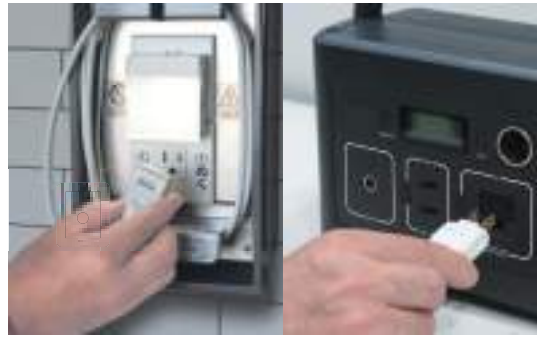
コンセントを抜き、車載コンセントやポータブル電源につなぎます。
